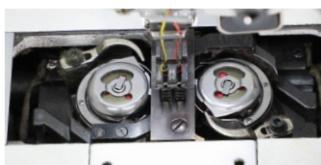
双直刀剪线机构反应速度快，在更换针位时方便剪线调整，使用粗线时效果特别明显。
