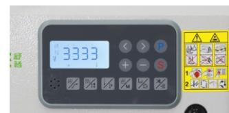
通过在操作盘上简单的数字设定，可以调整缝纫速度、设定上下停针位，计算已缝制的针数作为生产计数器使用等各项功能。
