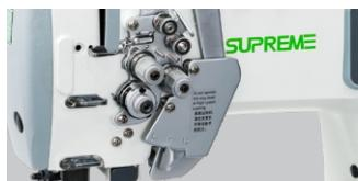
角缝双针机设有停住其中一根针杆运行的装置，能实现转角缝。
