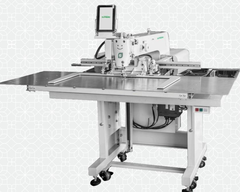
SP系列电子花样机，高效美观的缝制效果，缝制范围更广，适用性更强，使用节能技术，机器更节能环保。
